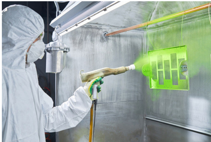
Şekil 16 Tribo tabanca ile uygulama[4]
