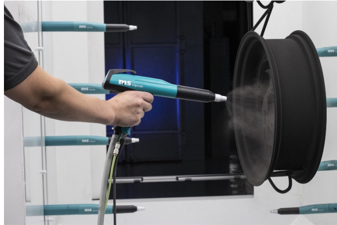
Şekil 14 Corona tabanca ile uygulama[3]
