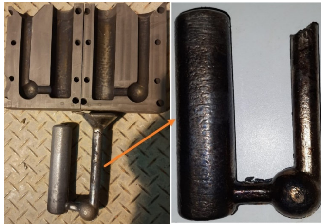
Şekil 2. İnvar 36 numunelerinin döküldüğü grafit kalıp ve örnek bir ingot numune
