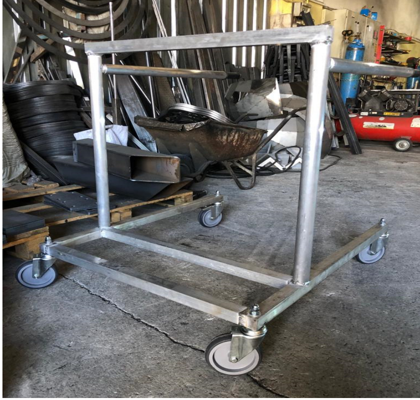
Şekil 2.4 Üst-alt şase ve tekerleklerin montajı yapılmış prototip
