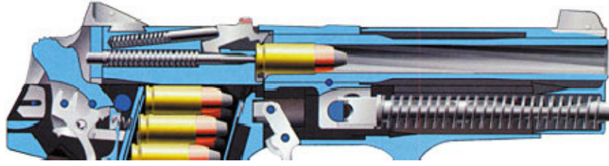
Şekil 1. Merminin namlu içindeki hareketi
