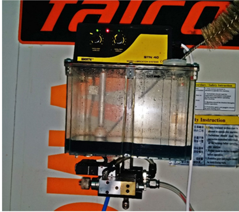
Şekil 3: Minimum Miktarda Yağlama Ünitesi
